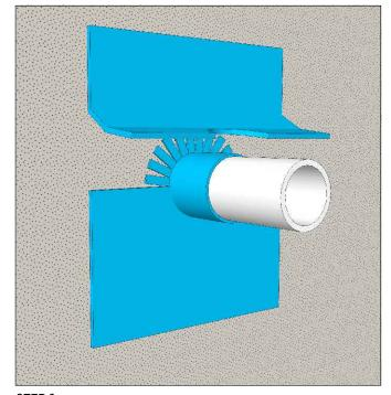
STEP 2 INSTALL A MEMBRANE ON THE WALL TO COVER THE LOWER HALF OF THE PIPE.
